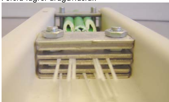
Andra lagret dragavlastat.
