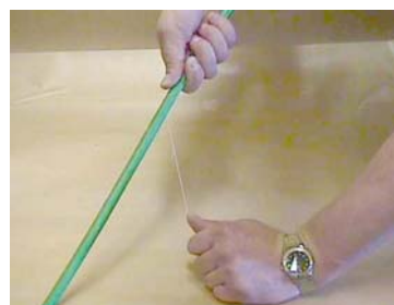
Skalning av kabel med hjälp av rivtråd
