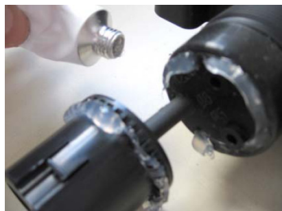
Applicera silikonfett runt kabelguide och packning
