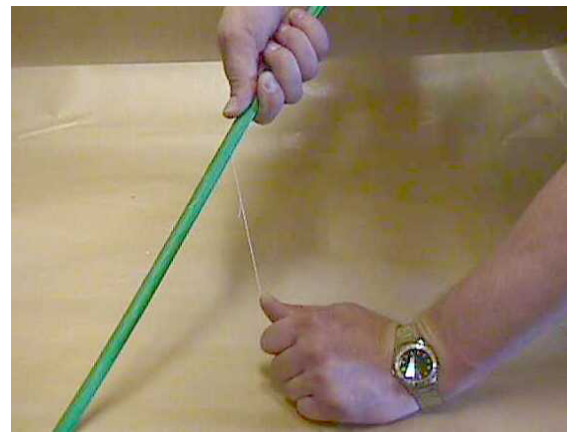
Skalning av kabel med hjälp av rivtråd
