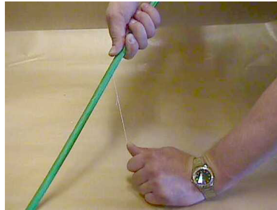
Skalning av kabel med hjälp av rivråden
