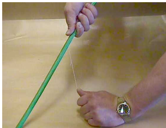
Skalning av kabel med hjälp av rivtråd
