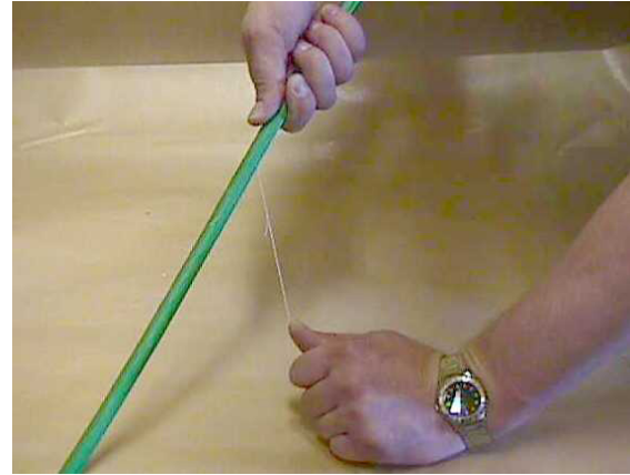
Skalning av kabel med hjälp av rivtråden
