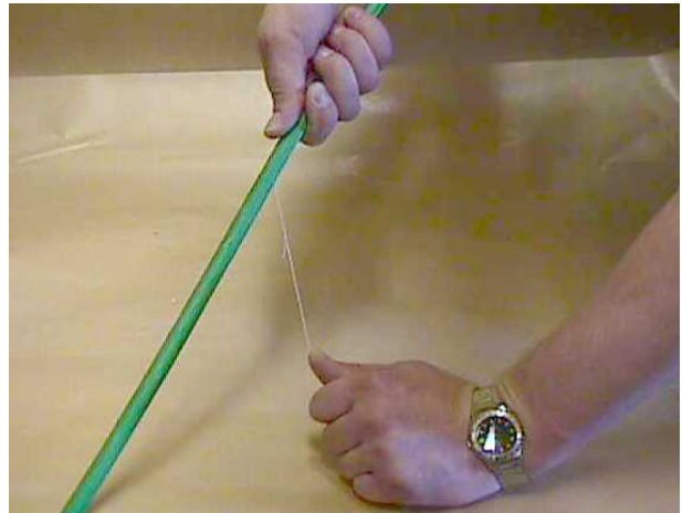
Skalning av kabel med hjälp av rivtråd
