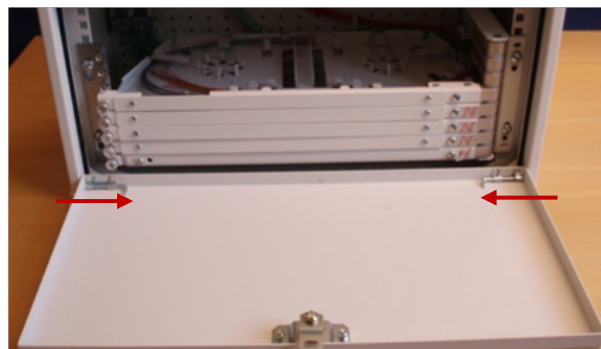
Montera bort luckan med genom att trycka ihop de fjäderbelastade gångjärnen.
