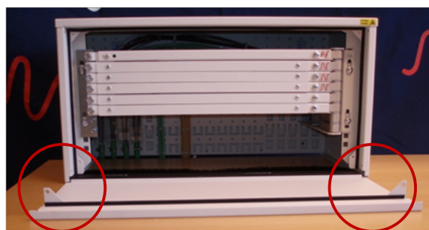
Montera bort botten genom att skruva loss de två skruvarna i vänster och höger hörn. Botten kan sedan dras ut.
